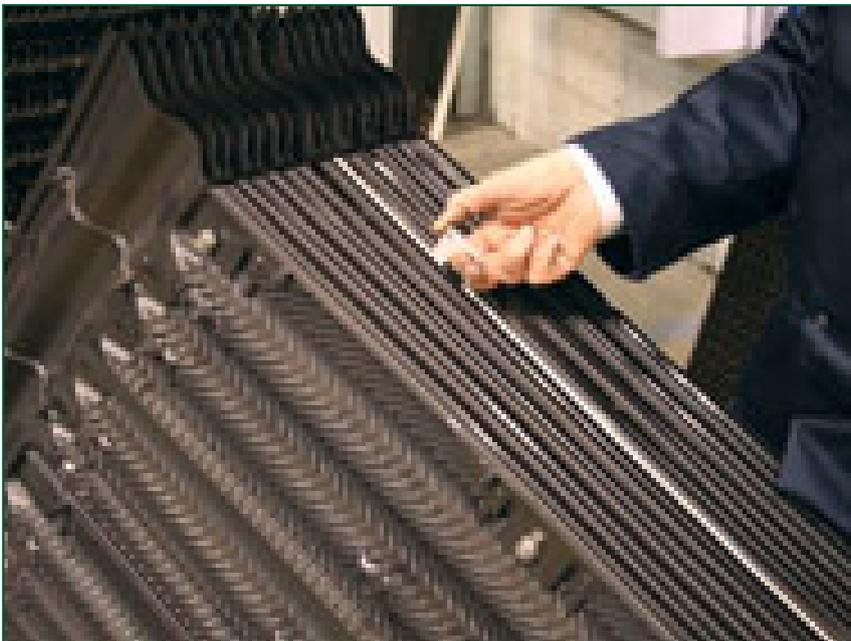
BACross<sup>®</sup>-Blöcke umfassen [BACross<sup>®</sup>-Füllkörperblechpakete](#) mit einem Griff zum Aufhängen der Blöcke am Füllkörperträger.
