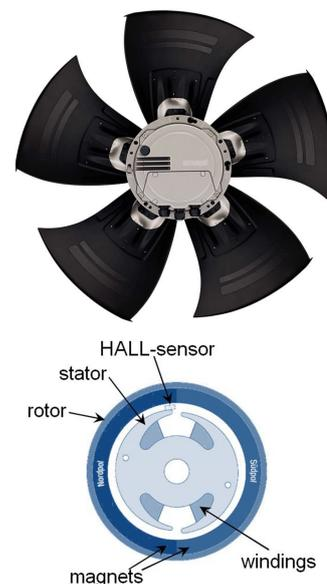
**Principio de funcionamiento:** el campo magnético de los imanes permanentes del rotor externo es utilizado por los devanados de accionamiento consecutivo situados en el estator interno para que el ventilador funcione. El sensor Hall detecta el punto más fuerte del campo magnético, que determina el conjunto de devanados que se activará.
