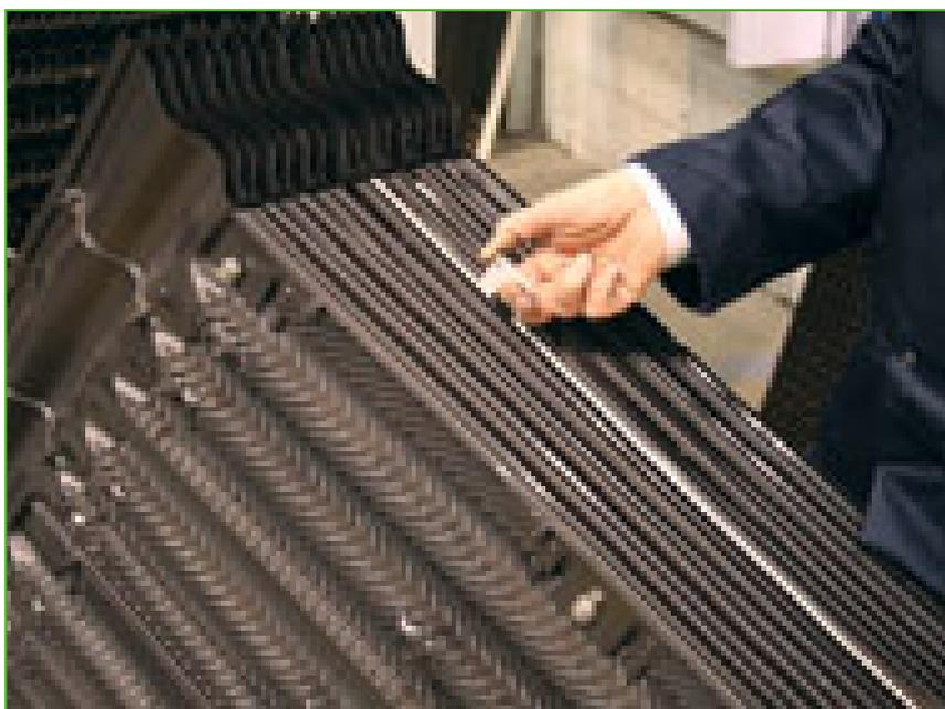
Los paquetes BACross incluyen [paquetes de láminas de relleno BACross](#) con un tirador para colgar los paquetes en el soporte de relleno.
