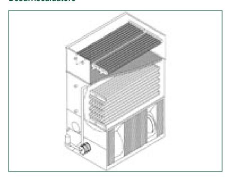
Il gas in uscita proveniente dai compressori alternativi ad ammoniaca (R-717) è altamente surriscaldato e deve essere **raffreddato** tramite la batteria di un desurriscaldatore prima di entrare nella batteria di condensazione.
