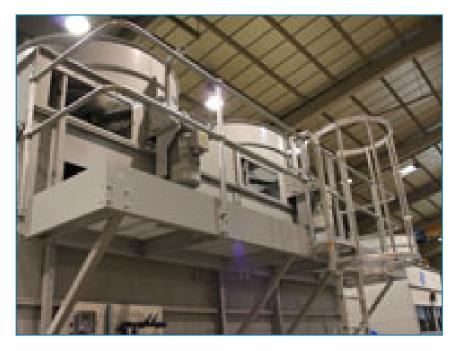
Le piattaforme, la scala, la gabbia di protezione e le ringhiere permettono di accedere in modo **più semplice** e **più sicuro** al livello superiore dell'unità, agevolando le operazioni di ispezione e manutenzione, in conformità con gli standard di sicurezza europei.
