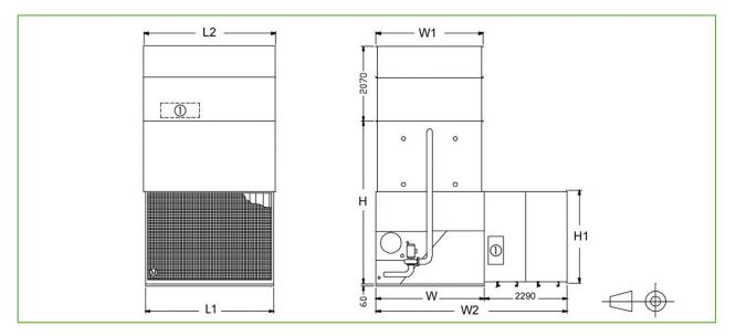
1. Toegangsdeur: L = Toestellengte; W = Toestelbreedte; H = Toestelhoogte (zie Technische Gegevens).
