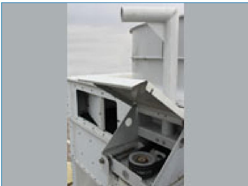
С помощью направляющих для демонтажа мотора **спуск или подъем** мотора с/на верхушку изделия становится легким!
