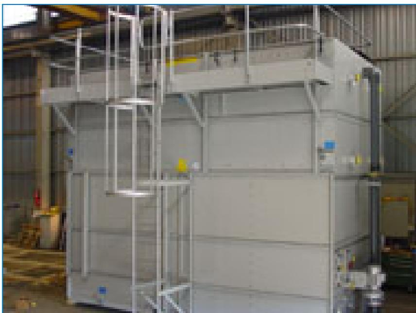
Платформы обеспечивают **более легкий** и **безопасный доступ** к **верхней части** изделия, делая осмотр и обслуживание более легкими и соответствующим европейским стандартам безопасности.
