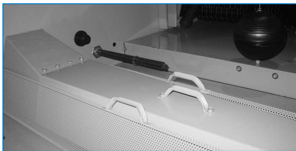
Nádrž na ochlazenou vodu a filtry nádrže
