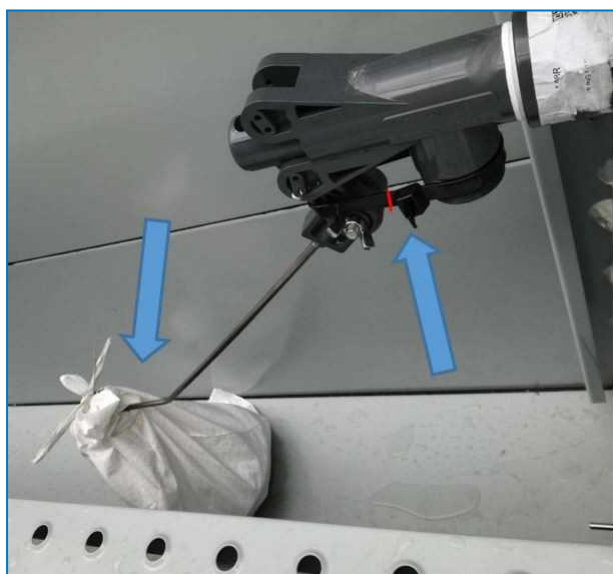
Фиксация и упаковка поплавка
