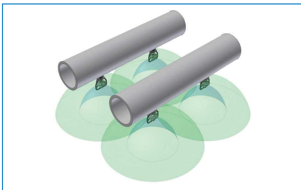
Тип разбрызгивания из форсунок для конденсатора
