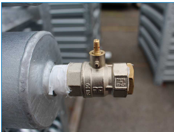
Felső csőköteg-csatlakozás nyomásmentesítő szeleppel kondenzátorok.
