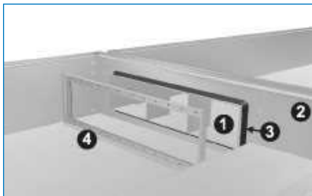
Installazione dell'anello di supporto
