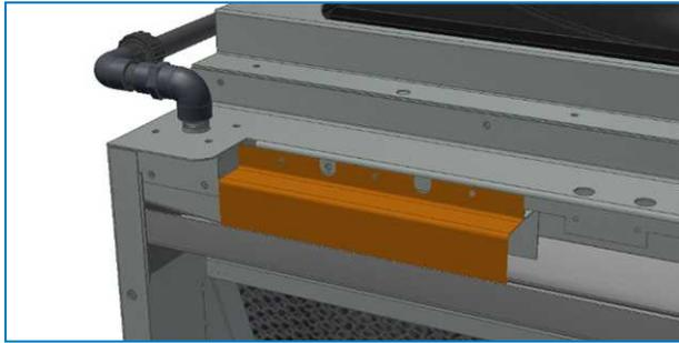
13. Instale la cubierta trasera en el otro lado y fjela en su posición con un tornillo roscado en el orificio central.
