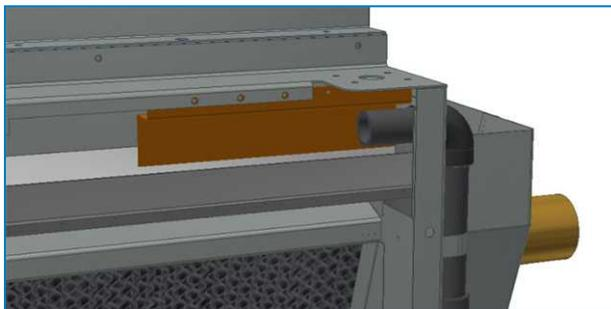
14. Instale la última cubierta delantera y fjela en su posición con tornillos roscados en los orificios adyacentes.
