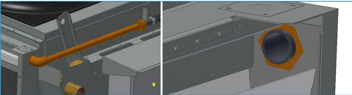
18. Para un equipo con dos bombas, instale la tubería premontada en el exterior y fijela en su posición con la cinta. Coloque el codo en la parte posterior y conecte la línea de impulsión de la bomba.
