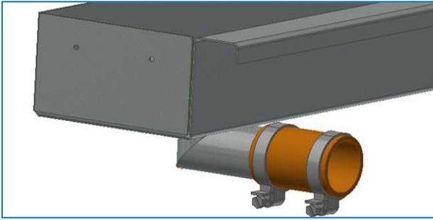
20. En caso de que el canalón de recogida del agua inferior conste de varias piezas, únalas con el pasador y remaches después de poner sellante líquido en el pasador.
