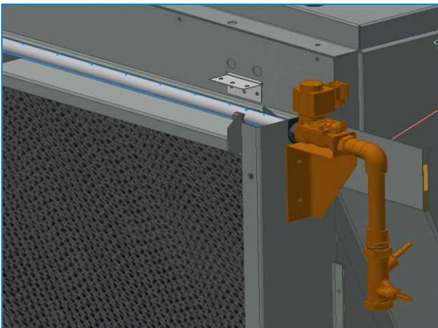
9. Con los orificios de la tubería apuntando hacia arriba, coloque un perno M5x50 a través de los ramales y las abrazaderas con una arandela de sellado en la parte superior y una arandela plana y otra de bloqueo en la parte inferior.
