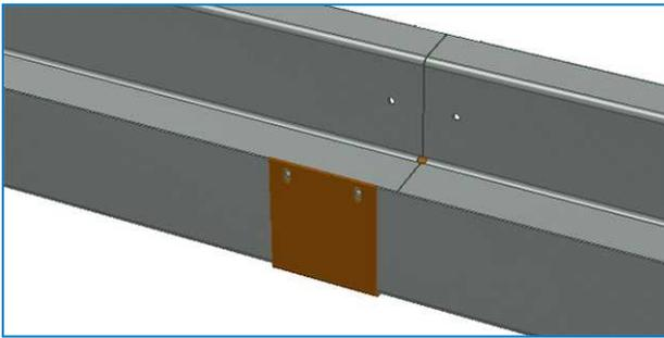
14. Instale el canalón inferior de recogida del agua sobre el bastidor.
