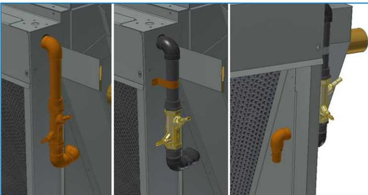
19. Inserte el manguito de caucho con abrazaderas en el vaciado del canalón de recogida del agua.
