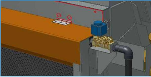
13. En caso de que el canalón de recogida del agua inferior conste de varias piezas, únalas con el pasador y remaches después de poner sellante líquido en el pasador.
