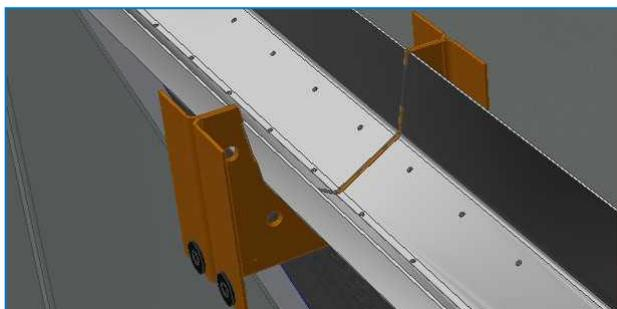
3. Instale el canalón de distribución de agua superior entre los paneles laterales con el lado más alto hacia la batería de enfriamiento.
