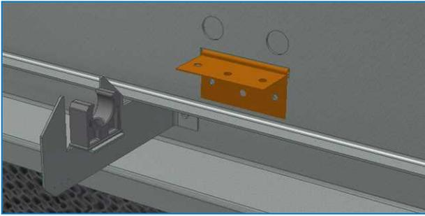
7. Instale la tubería de distribución de agua en las abrazaderas de tuberías con los orificios hacia arriba y la conexión roscada en el lateral con el panel eléctrico. En equipos largos, se tienen que unir varias tuberías con un manguito de goma.
