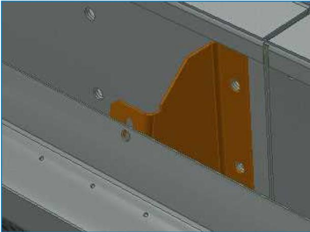
5. Asegúrese de que el canalón se instale nivelado y haga los ajustes necesarios para una correcta distribución de agua.
