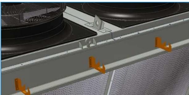
3. Instale las abrazaderas de las tuberías en los soportes para las tuberías.
