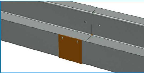
21. Instale el canalón inferior de recogida del agua sobre el bastidor.
