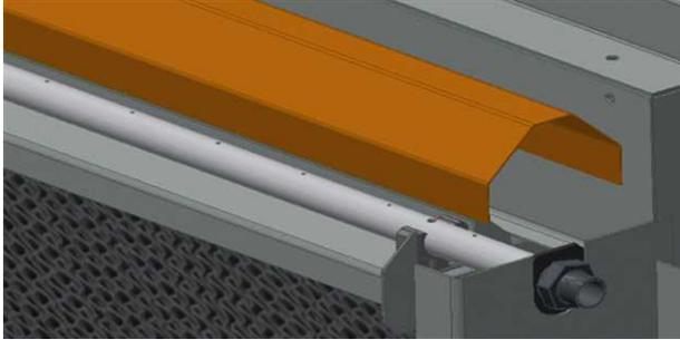
11. En caso de tapa superior dividida (TVC EC 8024, TVC EC 8025, TVC EC 8026 o TVC EC 8027) instale dos soportes en el deflector central, como se muestra a continuación.
