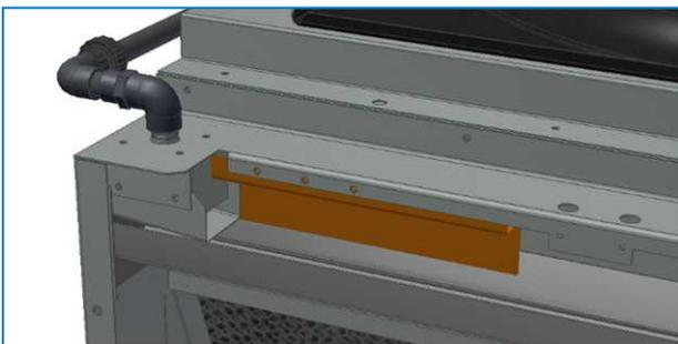
12. Instale la cubierta delantera en el cuadro de llenado y fjela en su posición con tornillos roscados en los orificios adyacentes.
