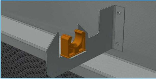
4. Tome el panel superior, instale los soportes de gancho en forma de L en la parte posterior y coloque el gancho a través de la ranura (la brida en la parte inferior del panel superior apunta hacia delante). Apriete el perno pero no demasiado apretado, de modo que el gancho pueda seguir girando libremente.
