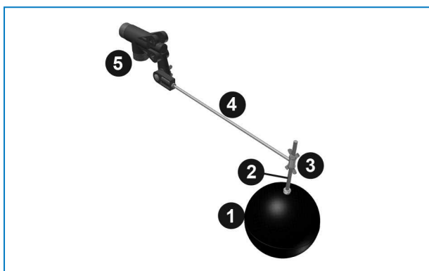
Estrutura da válvula de reposição
