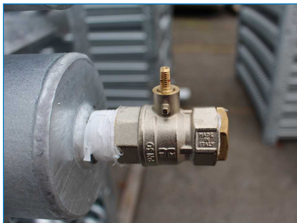
Övre slingkoppling med övertrycksventil på kondensorer.
